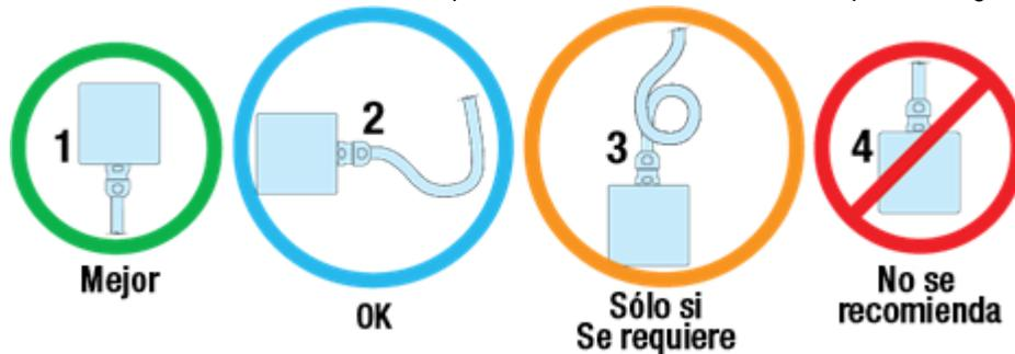
Figura 5.1: Trazado recomendado del cableado de ServoWeld.
