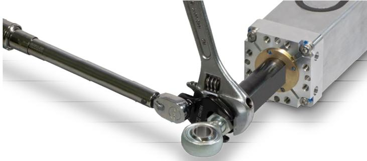
Figura 4.4: En el caso de la varilla en "doble d", mantenga la varilla de empuje estacionaria utilizando una llave en la parte plana de la varilla cuando fije los accesorios, los enlaces o la carga al actuador. Utilice una llave dinamométrica para apretar el extremo de la varilla de interconexión al punto de conexión roscado del actuador. Valores de par de apriete indicados en la Tabla 2.2
