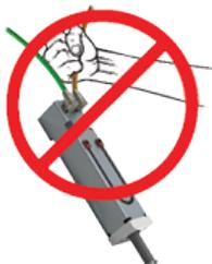
El rango de peso del actuador CSW(X) ServoWeld™ es de aproximadamente 10,2 a 15,6 kg (22,6 a 34,5 lb). Se debe tener especial cuidado al levantar este dispositivo. No lo transporte por los conectores. Los conectores no están preparados para soportar el peso del actuador.
