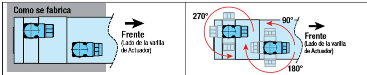
Figura 5.2: Rotación del conector. Obsérvese que los conectores estándar de Tolomatic pueden girarse de  $-90^\circ$  a  $+180^\circ$ , lo que permite que los cables se conecten hacia la parte delantera (extremo de la varilla, tal como se fabrica), a cualquier lado, a ambos lados o a la parte posterior del actuador.
