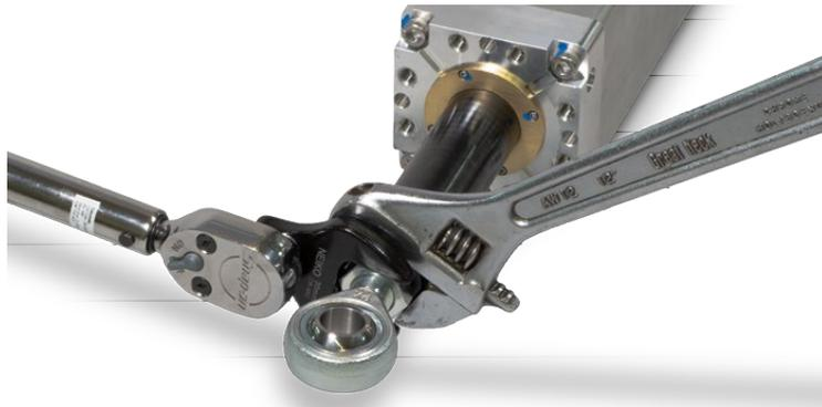
Figura 4.3: En el caso de la varilla redonda, mantenga fija la varilla de empuje utilizando una llave en las partes planas del extremo de la varilla cuando fije los accesorios, las conexiones o la carga al actuador. Utilice una llave dinamométrica para apretar el extremo de la varilla de interconexión al punto de conexión roscado del actuador. Valores de par de apriete indicados en la Tabla 2.2
