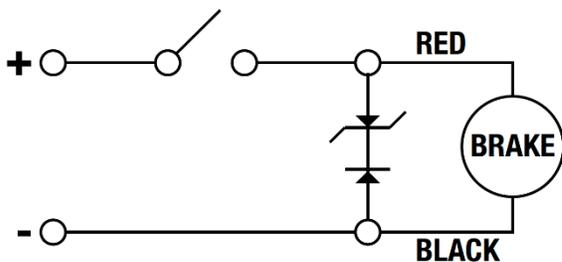
Figura 6.3: Aumento del tiempo de conexión/desconexión, mejor protección
